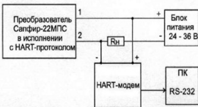
Рисунок 2.2 Схема подключения модема, исполнение обычное (вариант)
