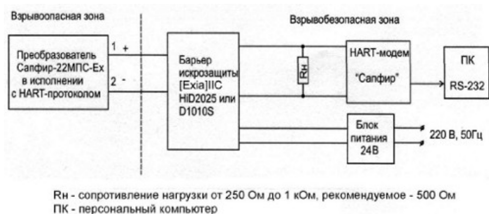
Рисунок 2.5 Схема подключения модема, исполнение Ex с барьером искрозащиты
