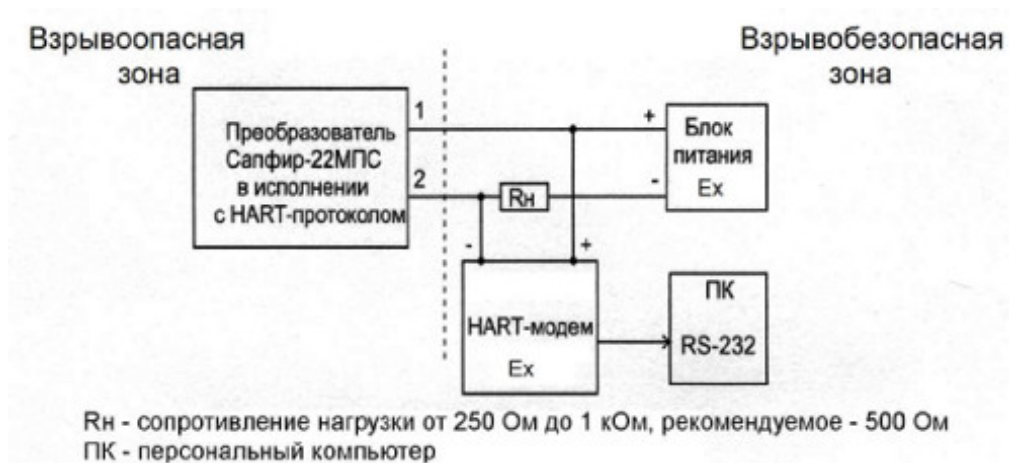
Рисунок 2.5 Схема подключения модема, исполнение Ex с барьером искрозащиты
