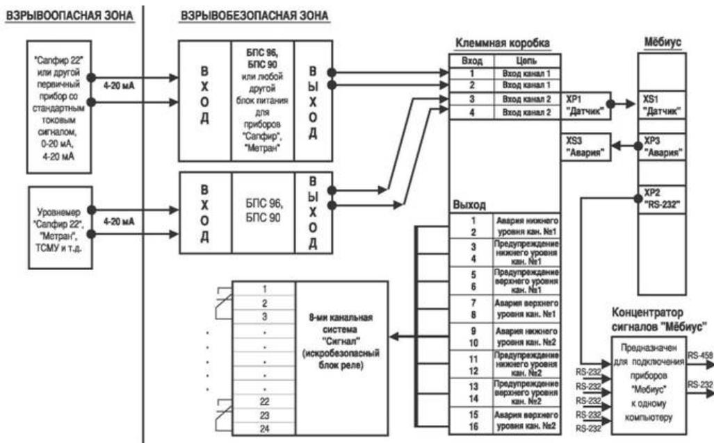
Рис. 2. Схема соединений первичных преобразователей типа «Сапфир-22», «Метран-22, 43» и др. в случае использования с устройством типа «Мебиус».
