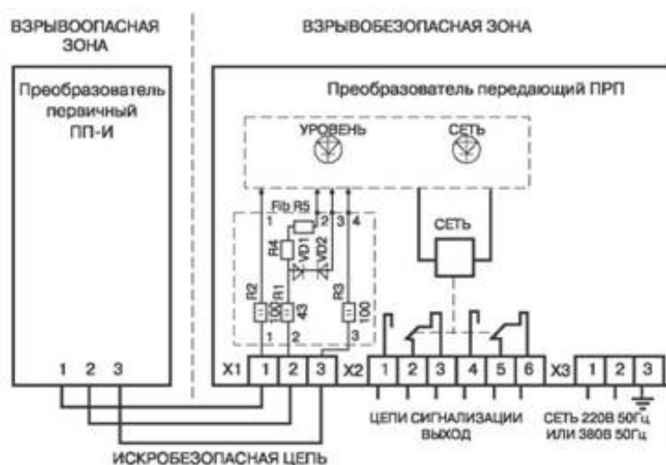
Рис. 4 Схема подключения датчика-реле уровня ROC-501И
