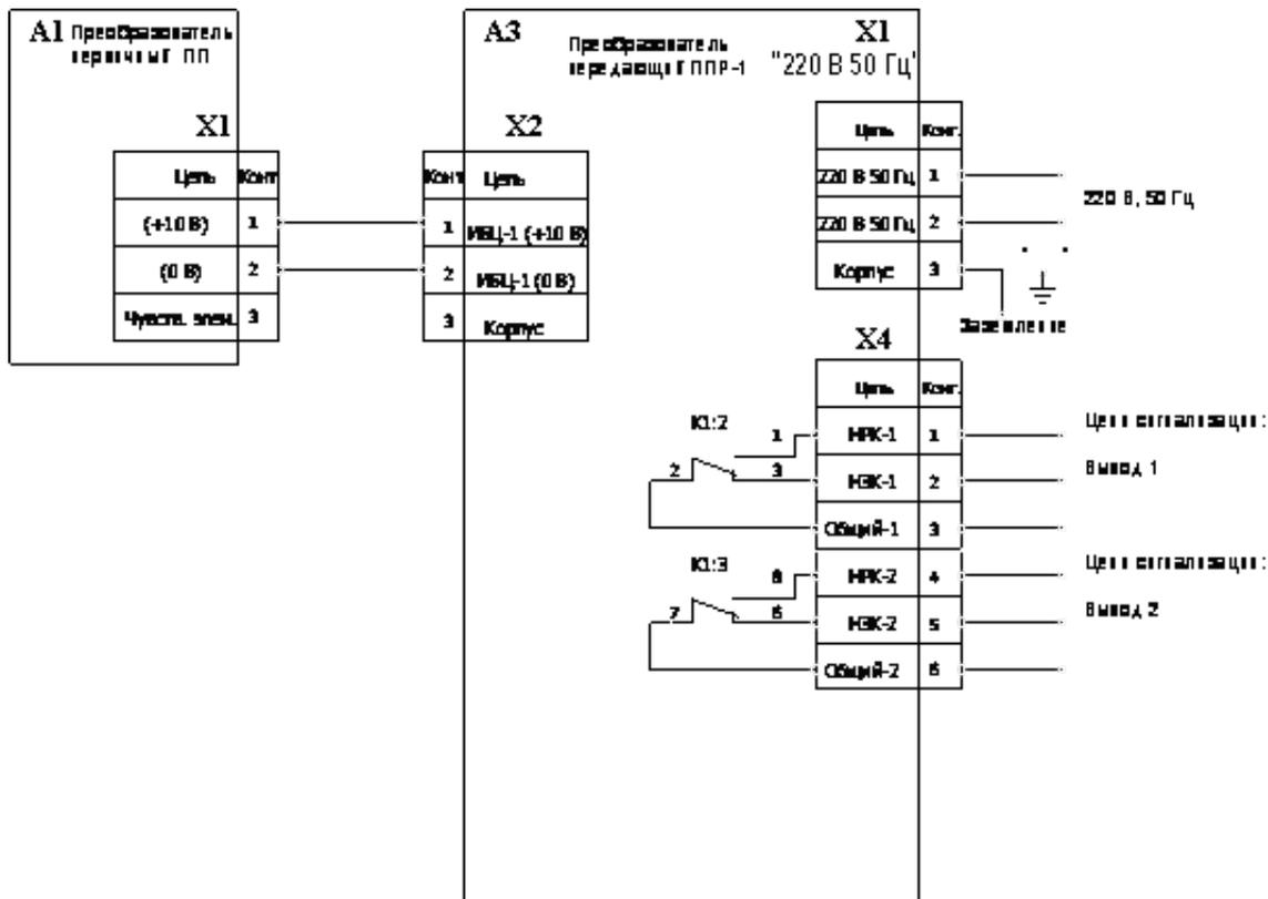
Рис. 4. Схема подключения одноканального сигнализатора (взрывозащищенное исполнение)
